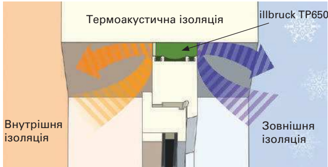
Багатофункціональна стрічка, що саморозширюється illbruck TP650 illmod Trio
