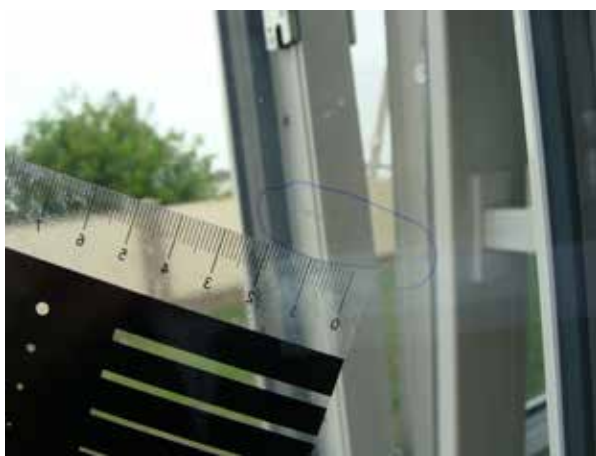
Приклад неприпустимого лінійного дефекту довжиною більше 15 мм в основній зоні склопакета
