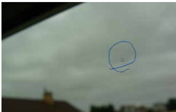
Приклад неприпустимого точкового дефекту \varnothing > 2 мм в основній зоні склопакета
